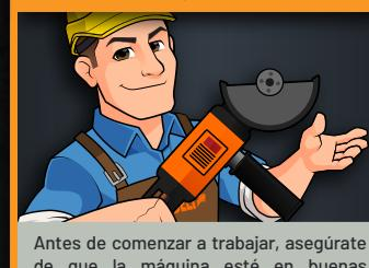
Antes de comenzar a trabajar, asegúrate de que la máquina esté en buenas condiciones. Para ello, Sin montar un abrasivo, realiza una prueba en vacío con la guarda puesta revisa la velocidad, el balance y detecta anomalías.
